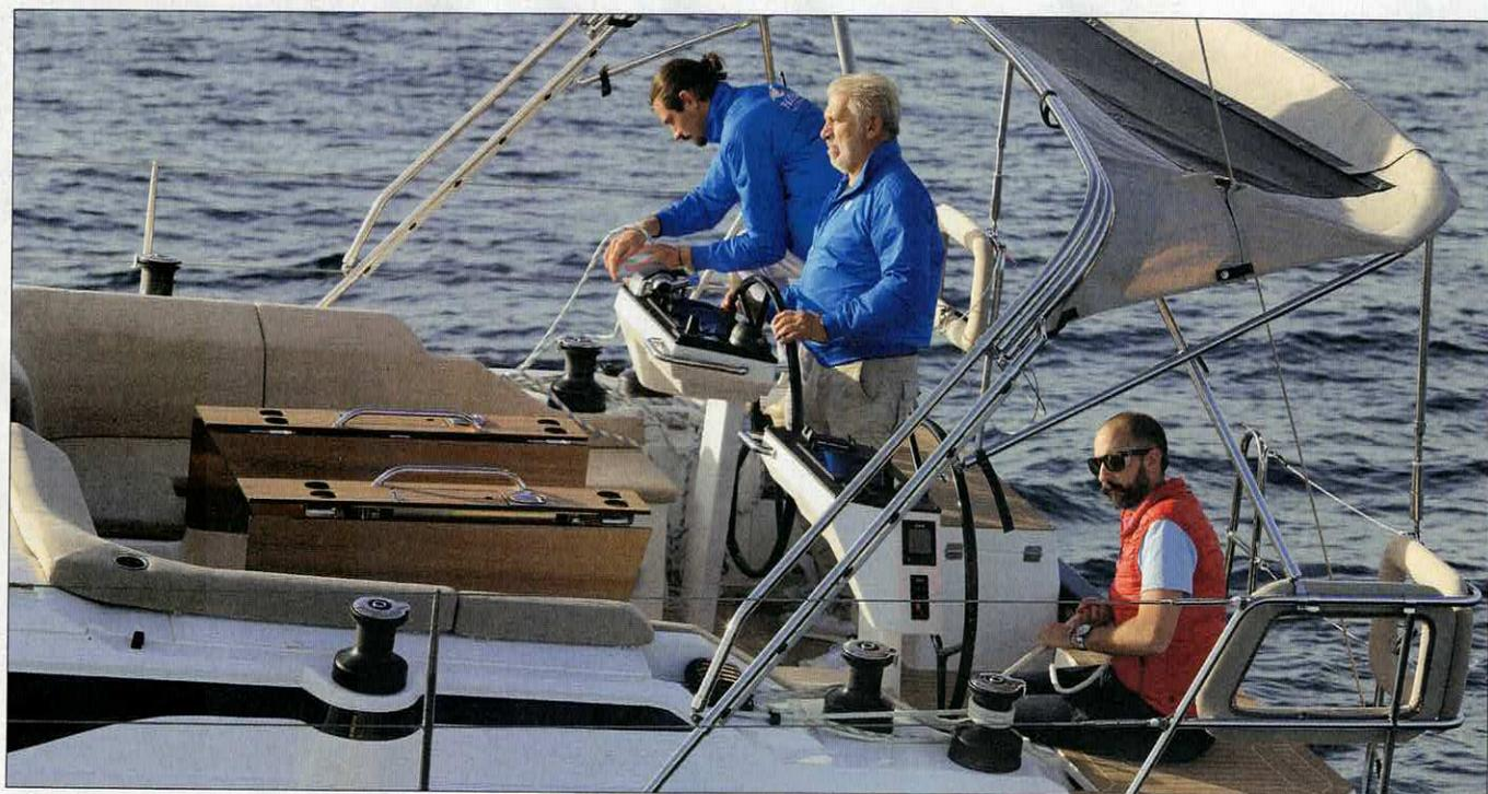
▲ Les manœuvres concentrées autour des postes de barre sont idéales pour une navigation en équipage réduit, mais l'équipier doit de préférence utiliser le poste où le barreur n'est pas. Les consoles de barre intègrent des afficheurs latéraux, face au barreur lorsque ce dernier est assis sur le passavant.
