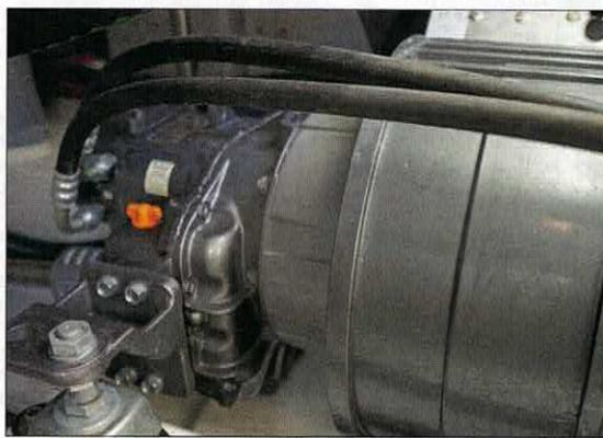
Cette dernière version du moteur hybride de Greenline dispose d'un nouveau système de refroidissement avec échangeur.
