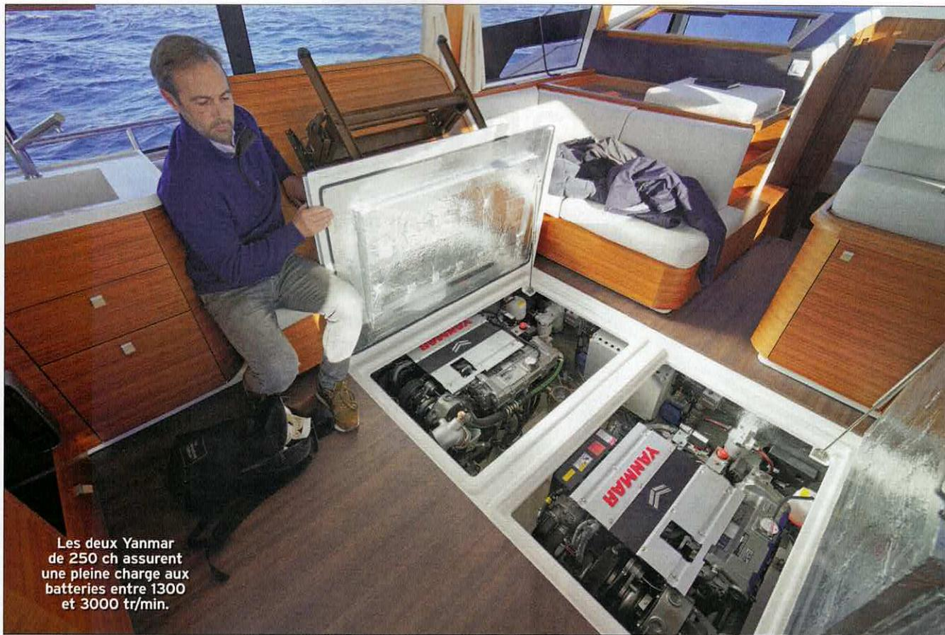
Les deux Yanmar de 250 ch assurent une pleine charge aux batteries entre 1300 et 3000 tr/min.
