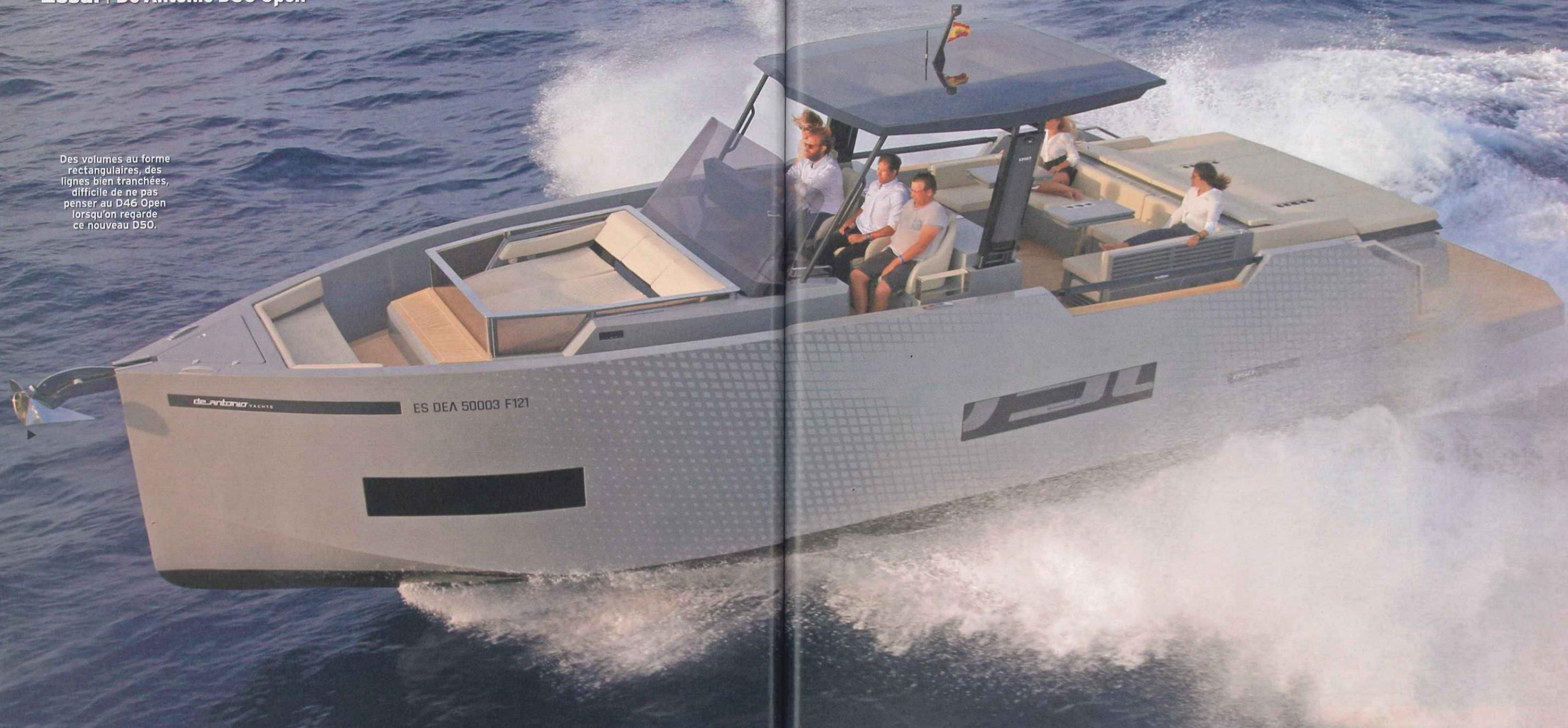
► avec ce monstre technologique. En attendant, le bateau de 15 mètres forme un couple solide avec les quatre Mercury, même si le poids total des blocs, supporté par un tableau arrière renforcé, avoisine 1,2 tonne! La carène à triple step, un dessin maison validé sur logiciel, se montre toujours aussi tonique et témoigne d'une réactivité surprenante compte tenu de la taille du day-cruiser.
