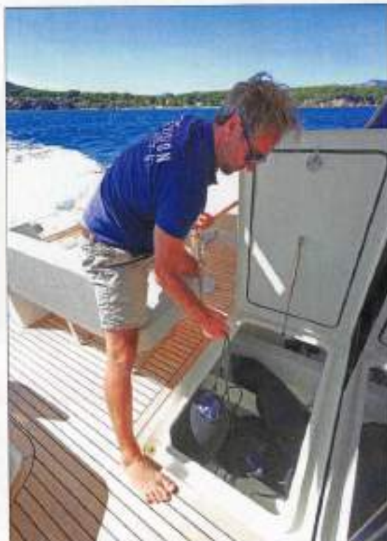
Une double soute sous le cockpit permet de stocker les défenses et le matériel de croisière. Le pont est garni d'éco-teck de 8 mm d'épaisseur. Une option à privilégier compte tenu du confort qu'il apporte.
